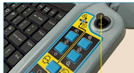
Contrôle en un clin d'oeil du touret/tracteur / de la caméra / lumière avec des joysticks et des touches de contrôle
