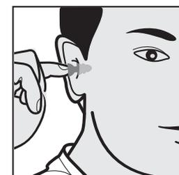
2. Insérez le bouchon dans le conduit auditif. Donner une légère rotation au bouchon pendant sa mise en place peut aider.
